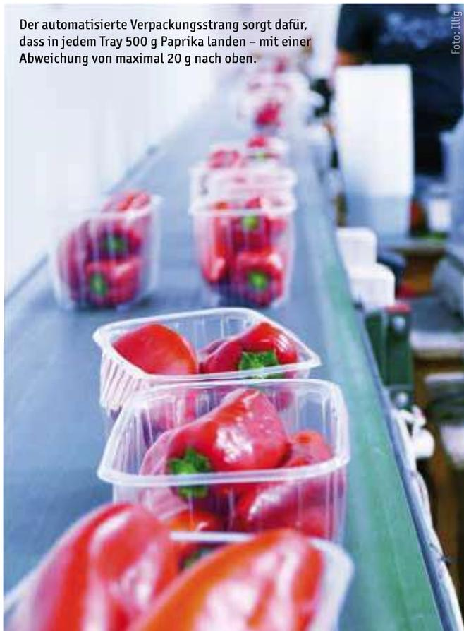
Der automatisierte Verpackungsstrang sorgt dafür, dass in jedem Tray 500 g Paprika landen – mit einer Abweichung von maximal 20 g nach oben.
